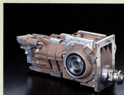
写真2：CATIA V3で初めて設計したミッションアセンブリ
