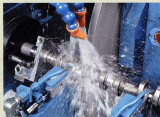
写真5：CNCカム研削盤によるカムシャフトの加工
