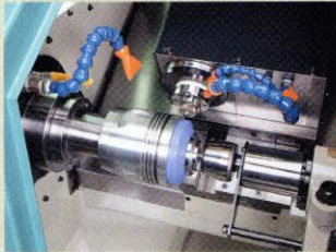
写真4：CNCピストン旋盤によるピストンの加工
