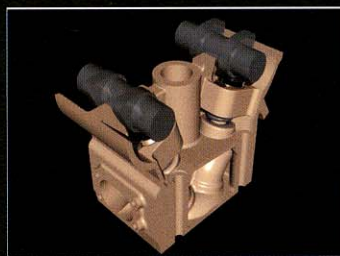
設計したシリンダーヘッドをPHSモジュールで写真のようにリアルなイメージに出力したもの。製品カタログ用の画像作成にもPHSを使う
